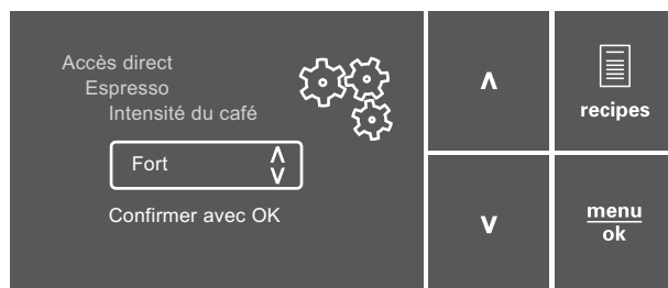
Fig. 6: Écran (exemple) et touches de commande pour la navigation
